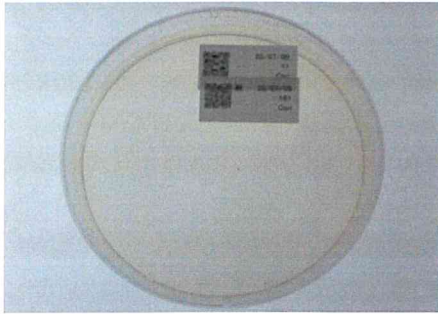
一般生菌数 標準寒天培地混釈培養 35±1°C、48±3時間培養
